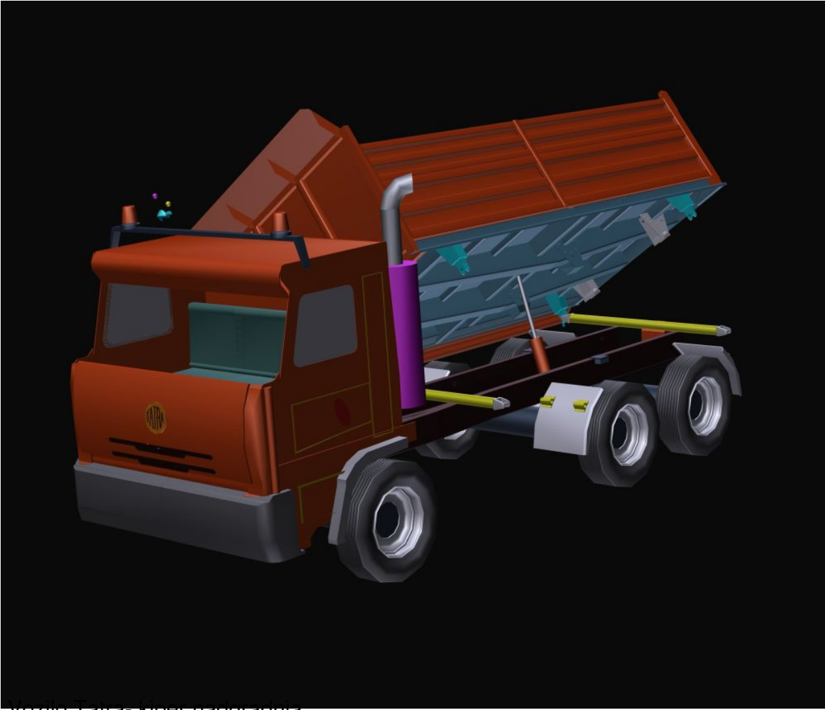
vozilo Patra- kiper nadgradnja
